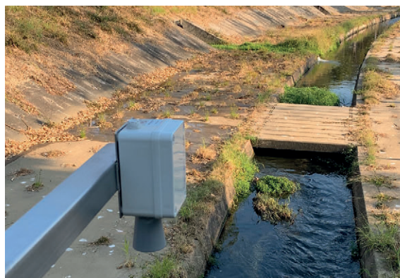
水位傳感器可實時監測河流和水道水位
